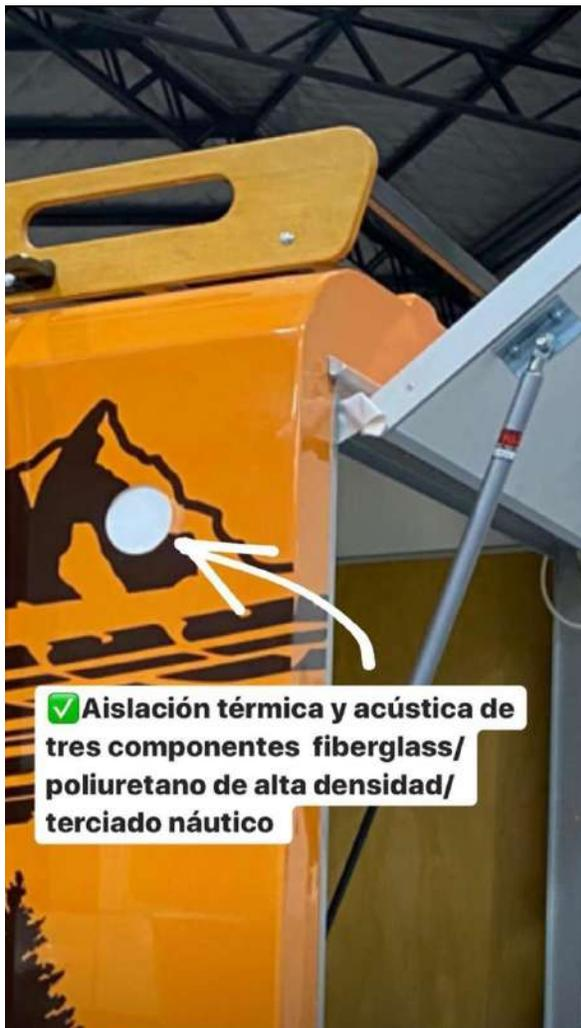
✓ Aislación térmica y acústica de tres componentes fiberglass/ poliuretano de alta densidad/ terciado náutico
